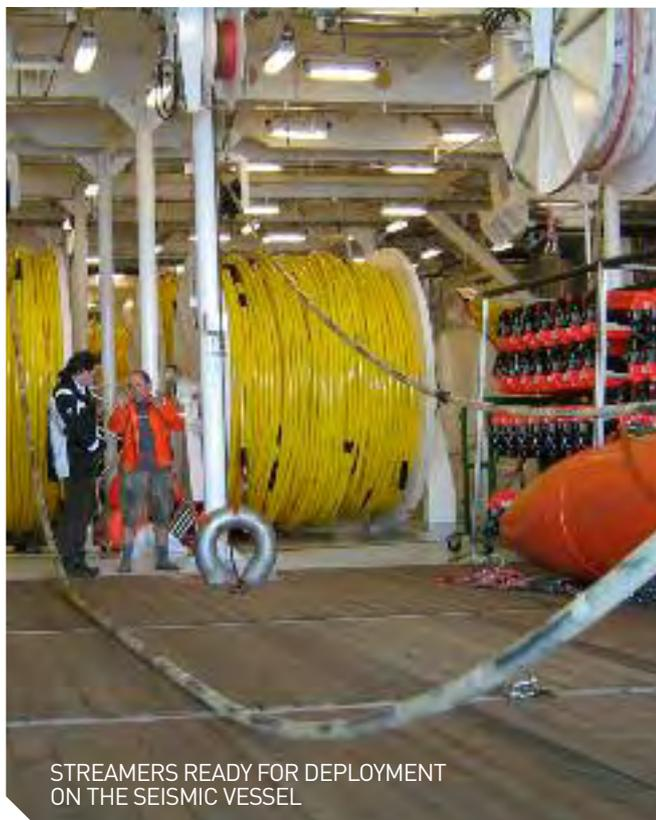
STREAMERS READY FOR DEPLOYMENT ON THE SEISMIC VESSEL
